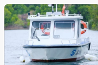
深圳松子坑水库多功能 电动无人巡检船
